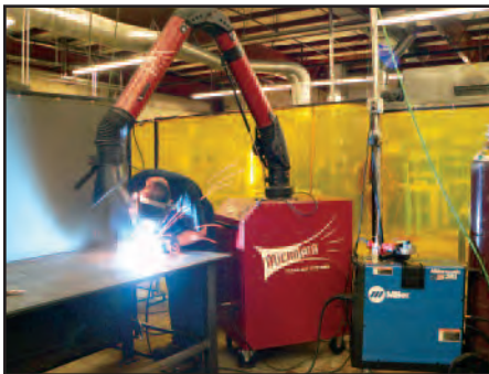
Colector Portátil TM1000 en Zona de Soldadura.
